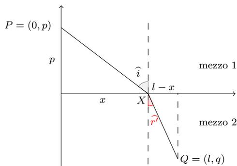
**Figura 5:** Legge della rifrazione:  $\frac{\sin \hat{i}}{\sin \hat{r}} = \frac{v_1}{v_2}$
