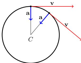
**Figura 4:** Nel moto circolare uniforme il vettore accelerazione  $\mathbf{a}$  è diretto verso il centro  $C$  del cerchio di rotazione e il suo modulo vale  $a = \frac{v^2}{r}$ .
