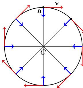
**Figura 1:** Moto di una particella che descrive la circonferenza di raggio  $r = 2$  con velocità unitaria. Il vettore accelerazione è indicato in blu e punta verso il centro della circonferenza, il vettore velocità è quello rosso e risulta in ogni istante tangente alla traiettoria.
