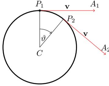
**Figura 2:** Moto circolare uniforme:  $P$  descrive il cerchio di centro  $C$  con velocità  $\mathbf{v}$ . Il modulo  $v$  (la distanza percorsa nell'unità di tempo) è costante. I vettori  $\overrightarrow{P_1A_1}$  e  $\overrightarrow{P_2A_2}$  hanno stessa lunghezza ma diversa direzione.
