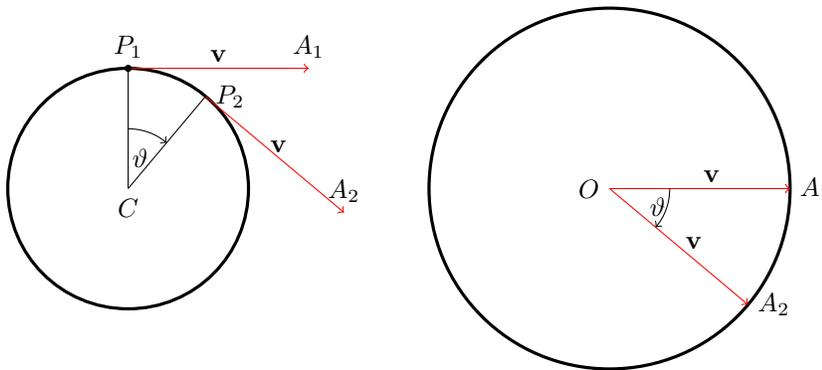
**Figura 3:** La rappresentazione di Hamilton dei vettori velocità. Quando  $P$  descrive il cerchio di centro  $C$  la punta  $A$  del vettore velocità descrive il cerchio di centro  $O$ .
